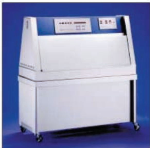
QUV/se 型配有太阳眼强度控制系统，该系统通过光强度的反馈回路控制，以达到最大精度的控制。
