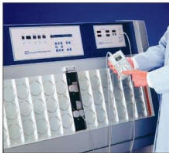
在专利产品AutoCal™ 系统的协助下，校准只需几秒钟，并且符合 ISO 9000 的要求。
